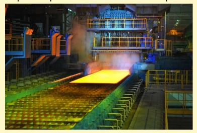
по ширине, а также уменьшить концевую обрезь промежуточных раскатов на 0,5-1% в зависимости от уменьшения ширины при редуцировании.
